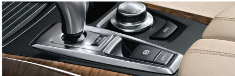
■ **Frein de stationnement avec fonction de maintien automatique du véhicule à l'arrêt Auto Hold.** Il suffit de tirer ou de pousser ce bouton placé sur la console centrale pour actionner ou relâcher le frein.
