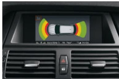
■ **Système d'aide au stationnement PDC** à l'avant et à l'arrière. Il facilite les manœuvres de stationnement sur les emplacements les plus étroits, la distance entre votre véhicule et un obstacle étant indiquée par des signaux sonore et visuel (sur l'écran de contrôle).
