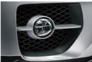
■ **Projecteurs antibrouillard** réalisés suivant la technique des formes libres. Intégrés à la jupe avant, ils garantissent une sécurité accrue par mauvaise visibilité.
