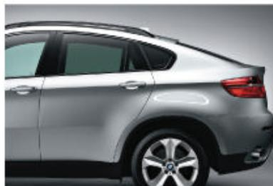
□ **Vitrage calorifuge** pour les vitres latérales arrière et la lunette arrière. Les vitres teintées réduisent l'éblouissement et garantissent une température intérieure agréable en cas de fort ensoleillement.
