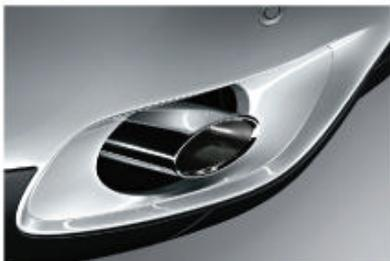
■ **Sorties d'échappement** : les BMW X6 xDrive35i, X6 xDrive30d et X6 xDrive35d sont équipées de série de deux sorties d'échappement simples. Le système d'échappement est réalisé en acier inoxydable de haute qualité. Les sorties d'échappement apparentes sont cerclées de chrome.
