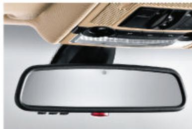
■ **Rétroviseur intérieur et extérieurs à anti-éblouissement automatique** selon l'intensité des rayons lumineux qui s'y réfléchissent. Les rétroviseurs extérieurs sont par ailleurs rabattables.
