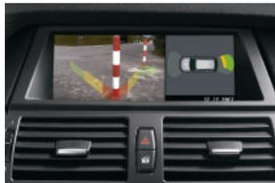
□ La **caméra de recul** filme l'espace derrière le véhicule, les images apparaissant sur l'écran de contrôle. L'affichage de trajectoires virtuelles vous montre par exemple si une place de parking est assez grande pour pouvoir s'y garer. La caméra de recul est activée automatiquement au passage de la marche arrière.
