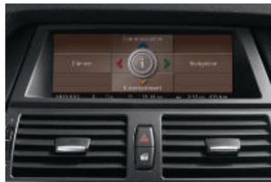
■ **Ecran de contrôle TFT** couleur 8,8 pouces. Il permet d'afficher les fonctions commandées par l'intermédiaire du « Controller » telles que l'ordinateur de bord, l'autoradio, la climatisation ou le système de navigation.
