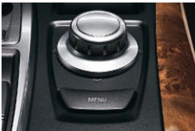
■ Le « **Controller** » est l'élément central du système iDrive (pour le conducteur et le passager avant). Cette molette-poussoir permet d'accéder à des fonctions supplémentaires qui s'affichent sur l'écran de contrôle. Les menus suivants sont disposés selon les quatre points cardinaux : climatisation, communication, navigation, divertissement et informations de bord.
