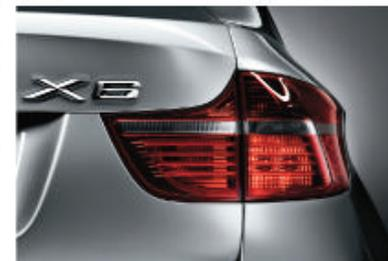
■ **Feux de stop dynamiques**. Ils permettent aux véhicules qui vous suivent de mieux apprécier l'intensité de votre freinage. Lors d'un freinage normal, les feux de stop s'allument sur une large surface. En cas de freinage appuyé, le feu de stop clignotent. Ceux qui vous suivent peuvent ainsi faire immédiatement la distinction entre un léger freinage et un freinage d'urgence – pour encore plus de sécurité.
