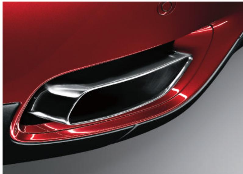
■ **Sorties d'échappement** : le système d'échappement avec deux sorties rectangulaires est réalisé en acier inoxydable de haute qualité. Des embouts chromés décorent les sorties. De série uniquement sur BMW X6 xDrive50i.
