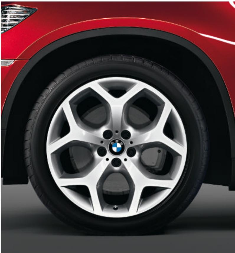
□ **Jantes BMW en alliage léger 20" style 214 à rayons en Y\*\*** avec monte pneumatique mixte RSC permettant le roulage à plat. Dimensions 10 J x 20 pouces à l'avant, pneumatiques 275/40 R 20 ; 11 J x 20 pouces à l'arrière, pneumatiques 315/35 R 20.
