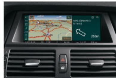
■ **Système de navigation Professional** avec écran couleur 8,8 pouces. Guidage par indications vocales et fléchées ou par carte. La fonction de fractionnement de l'écran permet d'afficher simultanément plusieurs menus, par exemple ceux de l'autoradio et du système de navigation.
