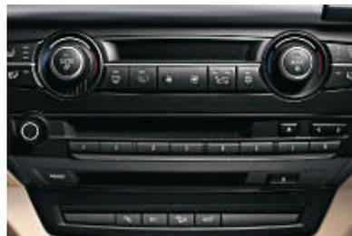
■ **Autoradio BMW Professional**, avec amplificateur 4 canaux, 6 haut-parleurs, double tuner, système d'antenne à réception multiple Diversity, fonction scan, lecteur CD et compatibilité MP3.
