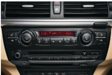
■ **Climatisation automatique bi-zone**, avec recyclage automatique de l'air AUC, filtre pour air recyclé, capteurs de buée et d'ensoleillement, régulation automatique de la température (individuelle pour le conducteur et le passager avant), régulation du débit, affichage et commande via l'écran de contrôle.
