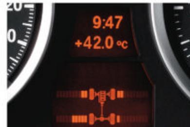
■ **Afficheur du Contrôle Dynamique de la Transmission** au tableau de bord. Il indique la répartition du couple entre les essieux avant et arrière (par la technologie xDrive) et entre les roues arrière (par le Contrôle Dynamique de la Transmission).
