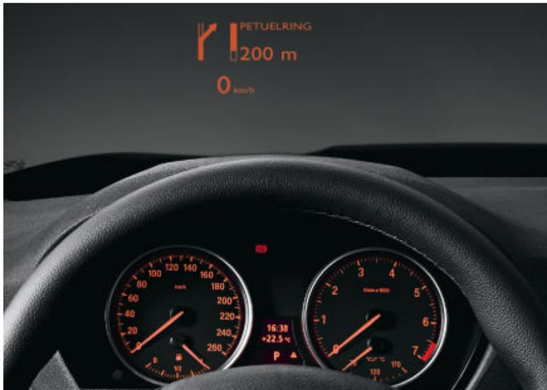
□ **Affichage tête haute HUD** projetant directement sur le pare-brise des informations de conduite telles que la vitesse instantanée ou les indications fléchées du système de navigation. Le conducteur peut régler la hauteur de l'affichage et sa luminosité afin de pouvoir toujours se concentrer entièrement sur la route.
