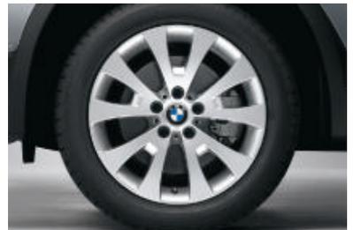
□ **Jantes en alliage léger BMW\*\*** style 206 à rayons en V, avec monte pneumatique mixte, à l'avant : 8 J x 18 pouces, pneumatiques 235/50 R 18 ; à l'arrière : 9 J x 18 pouces, pneumatiques 255/45 R 18.
