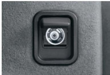
■ **Prise 12 V** intégrée au compartiment à bagages. Une deuxième prise 12 V se trouve sur la console centrale à l'arrière et une troisième à l'avant uniquement en combinaison avec le kit fumeurs.
