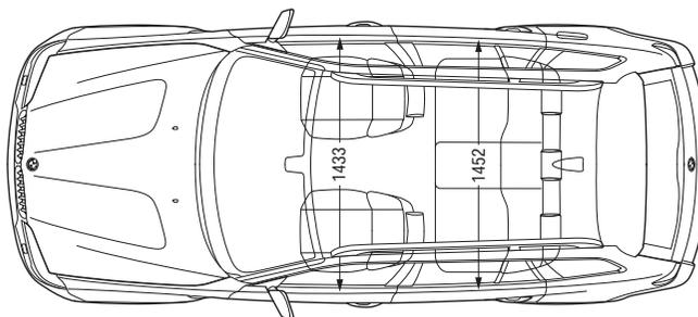
Toutes les cotes sont indiquées en millimètres. Capacité du compartiment à bagages : 480 à 1 560 litres (suivant VDA).
