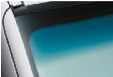
□ **Pare-brise Confort à traitement anti-infrarouge.** Il limite efficacement l'échauffement de l'habitacle par le biais d'une couche réfléchissant les infrarouges. Le bandeau dégradé sur le haut du pare-brise évite au conducteur d'être ébloui par le soleil.
