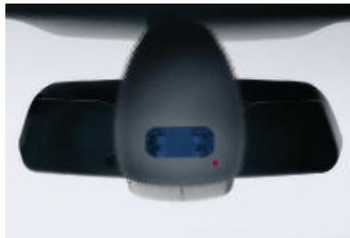
□ **Détecteur de pluie et allumage automatique des projecteurs**. Le détecteur de pluie enclenche les essuie-glaces dès les premières gouttes et commande la cadence du balayage en fonction de l'intensité de la pluie. L'allumage automatique des projecteurs actionne les feux de croisement dans un tunnel par exemple. Série sur les X3 xDrive35d 286 ch et X3 xDrive30i 272 ch.
