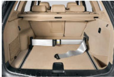
□ **Système de fixation modulaire** pour arrimer solidement des bagages de différentes tailles (disponible en combinaison avec le kit rangement).
