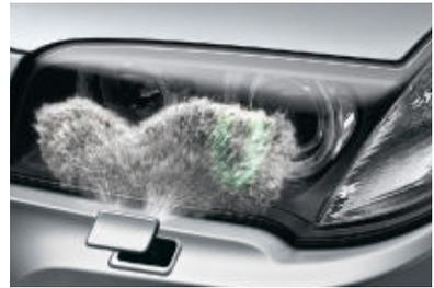
□ Les **lave-projecteurs** sont les garants d'une luminosité optimale des projecteurs par tous les temps. Lorsque les phares sont allumés et que le nettoyage du pare-brise est activé, les lave-projecteurs sont automatiquement mis en marche.
