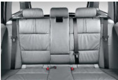
■ **Système de ceintures de sécurité** ergonomique à l'arrière, avec ceinture trois points à chaque place, boucles des ceintures à l'intérieur et trois appuis-tête (ceux de droite et de gauche étant réglables en hauteur).
