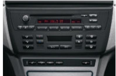
□ **Autoradio BMW Business CD,** puissance de l'amplificateur 6 x 25 W, système d'antenne à réception multiple Diversity, lecteur de CD intégré, chargement et éjection motorisés du CD. Le lecteur de CD est compatible MP3. Série sur les X3 xDrive30i 272 ch et xDrive35d 286 ch.
