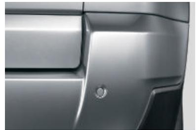
□ **Système d'aide au stationnement PDC** à l'avant et à l'arrière. Il facilite les manœuvres de stationnement sur les emplacements les plus étroits, la distance entre votre véhicule et un obstacle étant indiquée par un signal sonore.
