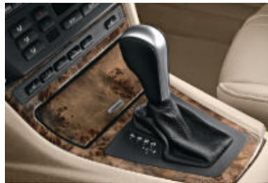
□ **Boîte de vitesses automatique à 6 rapports** avec Steptronic, commande auto-adaptative (AGS) et fonctions Shiftlock/Interlock. Elle permet des passages de rapports très rapides et confortables et garantit une dynamique de conduite maximale. Série sur la X3 xDrive35d 286 ch ; non disponible sur la xDrive20i 150 ch.
