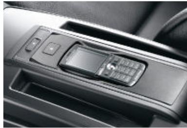
□ **Préparation pour téléphone Bluetooth** avec dispositif mains libres, connexion pour recharge et antenne. Un adaptateur (accessoire d'origine BMW) permet de raccorder un portable Bluetooth et de le commander via les touches multifonctions ou le système de navigation. Pour de plus amples informations sur les portables compatibles, veuillez vous adresser à votre Concessionnaire BMW.
