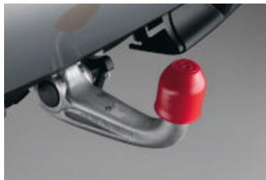
□ **Crochet d'attelage** avec rotule amovible et système de stabilisation de l'attelage. Ce système, intégré au DSC+, est activé lorsque la remorque est raccordée à la prise située à l'arrière. Une suspension adaptée sur l'essieu arrière compense le poids supplémentaire provenant de l'attelage.
