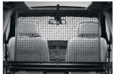
□ **Filet de séparation du compartiment à bagages.** Un couvre-bagages amovible protège des regards indiscrets. Le filet peut être fixé au ciel de pavillon pour éviter que des objets ne soient projetés du compartiment à bagages vers l'habitacle : le compartiment à bagages peut ainsi être rempli jusqu'au pavillon sans risques pour les occupants. Série sur les X3 xDrive35d 286 ch et xDrive30i 272 ch.
