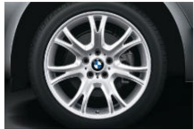
□ **Jantes BMW en alliage léger style 191M à rayons en Y, avec monte pneumatique mixte** : à l'avant 8,5 J x 19 pouces avec pneumatiques 235/45 R 19, à l'arrière : 9 J x 19 pouces avec pneumatiques 255/40 R 19.
