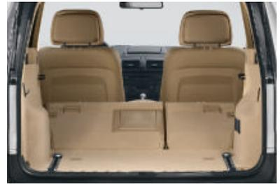
■ **Dossier de la banquette arrière** rabattable entièrement ou asymétriquement (60/40), pour augmenter la capacité du compartiment à bagages et l'espace utile.
