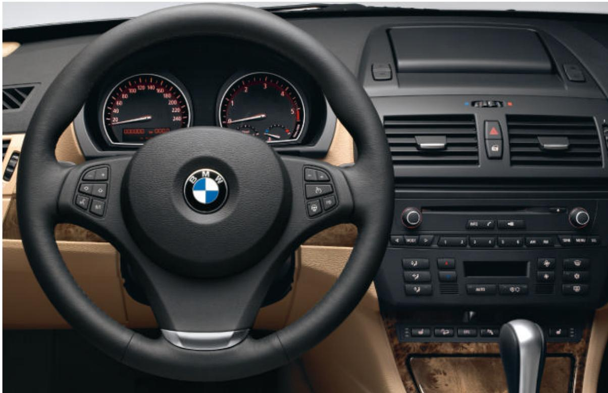
□ **Volant Sport gainé cuir** avec touches multifonctions pour le régulateur de vitesse et télécommande pour l'autoradio ou le téléphone portable (en option).
