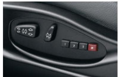
□ **Sièges avant électriques,** réglables sur plusieurs axes ; avec mémoires conducteur et rétroviseurs extérieurs électriques chauffants avec assistance au parking.
