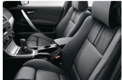
**Sièges avant Sport**. Les flancs hauts assurent un maintien latéral optimal en toutes circonstances. Avec réglages de la hauteur, de l'inclinaison et de la longueur de l'assise, de l'inclinaison du dossier et réglage longitudinal.
