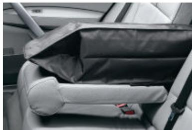
□ Le **sac à skis** permet de transporter en toute sécurité jusqu'à quatre paires de skis sans salir l'habitacle tout en laissant suffisamment d'espace pour quatre personnes dans le véhicule. Lorsqu'il n'est pas utilisé, il peut être rangé à l'abri des regards derrière l'accoudoir central pour économiser de la place. Série sur les X3 xDrive 35d 286 ch et xDrive30i 272 ch.
