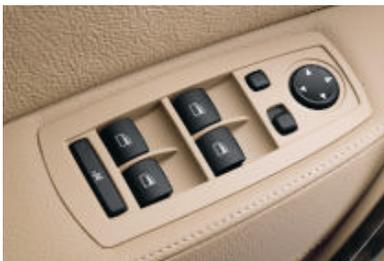
■ **Lève-vitres électriques** avec commande par impulsion, protection anti-pincement et fermeture confort sur toutes les vitres.
