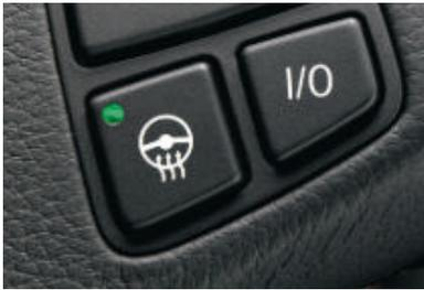
□ **Volant chauffant.** Il suffit d'appuyer sur un bouton pour faire chauffer rapidement la jante du volant, ce qui est particulièrement appréciable en hiver (disponible en combinaison avec le volant gainé cuir, le volant Sport gainé cuir ou le volant M gainé cuir).
