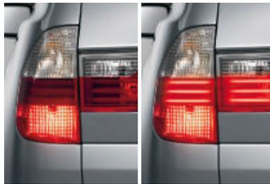
■ **Feux de stop bi-intensité.** Ils permettent aux conducteurs des véhicules suivants de mieux apprécier l'intensité de votre freinage. Lors d'un freinage appuyé, le champ lumineux des feux de stop arrière s'élargit. Ceux qui vous suivent peuvent ainsi faire immédiatement la distinction entre un léger freinage et un freinage d'urgence – pour encore plus de sécurité.
