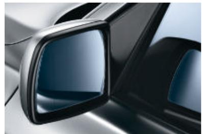
■ **Rétroviseurs extérieurs** dans la teinte de la carrosserie. Les miroirs asphériques, à réglage et dégivrage électriques, sont teintés en bleu.
