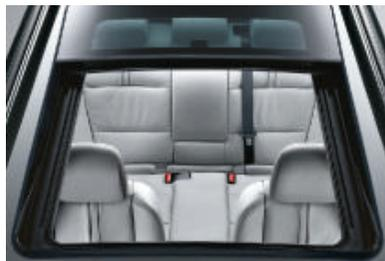
□ **Toit ouvrant panoramique en verre coulissant et entrebâillable électriquement** par simple pression sur une touche à impulsion, avec ouverture généreuse (0,65 m<sup>2</sup>), déflecteur d'air asservi à la vitesse, commande électrique, store pare-soleil de ciel de pavillon électrique, protection anti-pincement et ouverture/fermeture confort.
