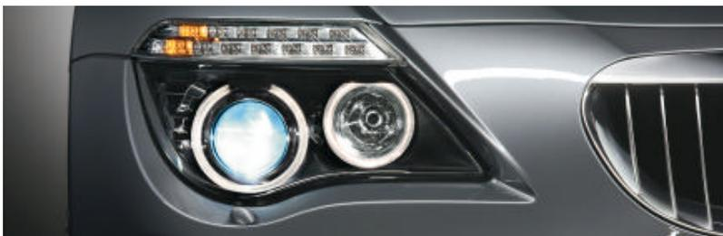
■ **Projecteurs bi-Xénon**, avec réglage automatique de la portée des projecteurs. Ils éclairent nettement la chaussée la nuit, même par mauvais temps ou lorsque la visibilité est réduite.
