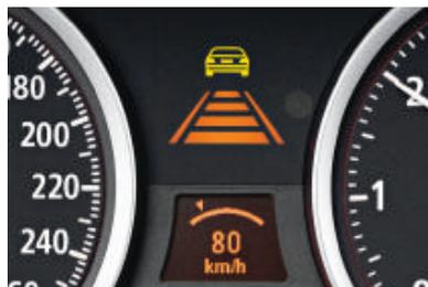
□ **Régulateur de vitesse actif ACC+.** Système d'aide à la conduite spécialement conçu pour un confort et une sécurité active accrus en circulation en files ininterrompues. Combine un régulateur de vitesse avec le maintien de la distance de sécurité. Ce système intelligent intervient de manière active sur les freins jusqu'à l'arrêt complet et redémarre automatiquement après des arrêts inférieurs à 3 s.
