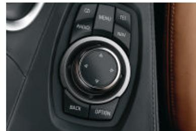
■ Le « **Controller** » est l'élément de commande central du système iDrive (pour le conducteur et le passager avant). Cette molette-poussoir permet d'accéder à de nombreuses fonctions qui s'affichent sur l'écran de contrôle. De nouvelles touches d'accès direct vous permettent d'accéder – de manière totalement intuitive grâce à la forme différente des touches – aux menus CD, autoradio, navigation et téléphone.
