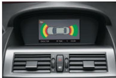
□ **Système d'aide au stationnement PDC** à l'avant et à l'arrière, avec signaux sonores et visuels. Il facilite les manœuvres de stationnement sur les emplacements les plus étroits, la distance entre votre véhicule et un obstacle étant indiquée par un signal sonore et représentée sur l'écran de contrôle.
