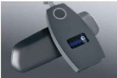
■ **Détecteur de pluie** et allumage automatique des projecteurs. Une fois activé, le détecteur de pluie commande la mise en route des essuie-glaces et règle la fréquence de balayage de manière autonome. L'allumage automatique des feux de croisement met en marche et éteint les projecteurs en fonction de la luminosité.
