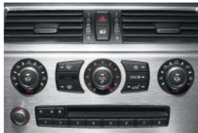
■ **Climatisation automatique à fonctionnalités étendues** avec commande automatique de recyclage de l'air (AUC), capteur solaire et capteur de buée, régulation automatique de la température et de la répartition de l'air (séparée côté conducteur et côté passager) et régulation automatique du débit d'air. Les affichages et réglages se font par le biais de l'écran de contrôle.
