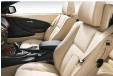
■ **Sièges de série, avec mémoires côté conducteur** (représentés ici dans la BMW Série 6 Cabriolet avec un garnissage cuir exclusif Pearl), à réglages électriques de la position longitudinale du siège, de la hauteur de l'assise et du dossier ainsi que de l'inclinaison de l'assise.
