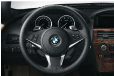
■ **Volant Sport gainé cuir** à trois branches, avec touches multifonctions. Les touches intégrées permettent d'activer l'autoradio, le lecteur CD et le téléphone (en option) tout en gardant les mains sur le volant. Deux touches peuvent même être librement programmées par le conducteur. Présentée ici avec la boîte de vitesses automatique Sport et ses palettes au volant.
