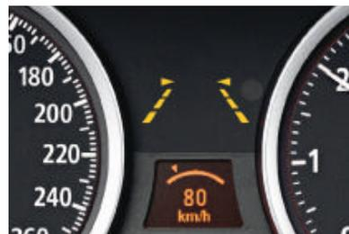
□ **L'avertisseur de franchissement de ligne** détecte grâce à une caméra tout rapprochement involontaire des lignes de délimitation de voie et avertit immédiatement le conducteur en faisant vibrer le volant. Ce système, conçu pour la conduite sur les routes nationales et sur autoroute, peut être activé ou désactivé à l'aide d'une touche sur le volant multifonctions.
