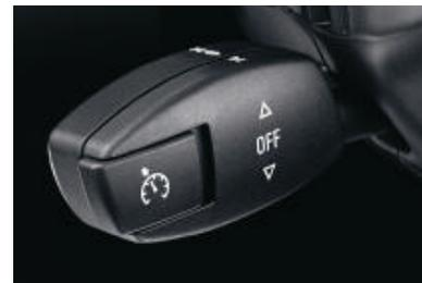
■ **Le régulateur de vitesse avec fonction freinage** enregistre la vitesse souhaitée à partir de 30 km/h et la maintient constante (actionnement par le biais du sélecteur se trouvant à gauche du volant). Après une accélération, le régulateur rétablit automatiquement la vitesse enregistrée au préalable. Lorsque vous freinez, cette fonction est désactivée, mais peut être rappelée d'une simple pression sur la touche adéquate.
