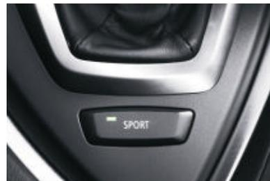
■ **La commande dynamique** (mode sport). Par simple pression d'un bouton, le moteur réagit encore plus spontanément aux pressions sur l'accélérateur. Cette commande réduit en parallèle l'assistance de la direction pour un meilleur ressenti de la route et raccourcit également le temps des changements de vitesses de la boîte de vitesses automatique Sport optionnelle.
