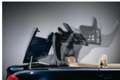
■ **Ouverture/fermeture de la capote entièrement automatique :** en appuyant sur une touche, vous pouvez ouvrir ou fermer la capote (lorsque le véhicule est à l'arrêt). La lunette arrière verticale peut être abaissée indépendamment de la capote. Il est également possible d'ouvrir ou de fermer la capote par le biais de la télécommande.
