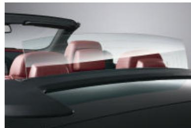
■ **Lunette arrière en verre, escamotable et dégivrante électriquement :** la lunette verticale s'abaisse et se lève indépendamment de la capote. Lorsque cette dernière est fermée, la lunette baissée assure une ventilation efficace de l'habitacle. Lorsque la capote est ouverte, la lunette arrière relevée offre un haut niveau de confort aux passagers arrière.
