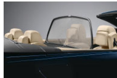
■ **Le filet anti-remous** permet de conduire les cheveux au vent sans courants d'air gênants au niveau des épaules et de la nuque. Facile à utiliser, il peut être rangé dans le compartiment à bagages lorsque vous n'en avez plus besoin.
