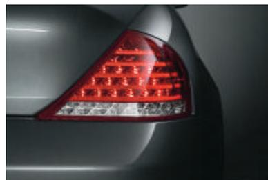
■ **Feux de stop bi-intensité**. Ils permettent aux conducteurs qui vous suivent de mieux évaluer votre situation de freinage. Lors d'un freinage léger, les trois rangées inférieures du bloc optique arrière s'allument en émettant une lumière rouge. Lors d'un freinage d'urgence, les deux rangées supérieures s'allument aussi avec une forte intensité lumineuse.
