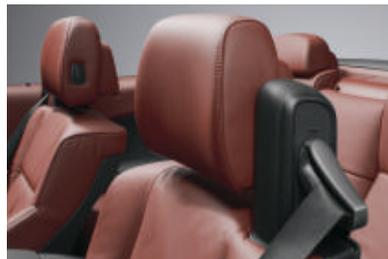
■ **Système de ceintures de sécurité intégrées aux sièges SGS** sur la BMW Série 6 Cabriolet : dans toutes les positions du siège, la géométrie de la sangle permet une protection optimale.
