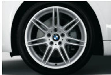
**Jantes BMW en alliage léger style 288 à rayons doubles** avec monte pneumatique mixte permettant le roulage à plat. Dimensions : à l'avant 8,5 J x 19 pouces, pneumatiques 245/50 R 19 ; à l'arrière 9 J x 19 pouces, pneumatiques 275/35 R 19.
