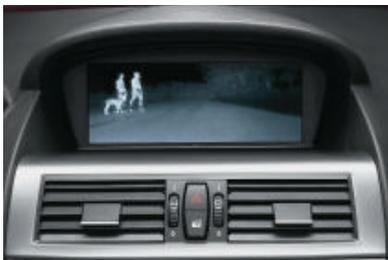
□ Le système de vision nocturne « **Night Vision** » retransmet directement sur l'écran de contrôle, à l'aide d'une caméra thermosensible, les images de personnes ou d'animaux se trouvant à une distance maximale de 300 mètres. Ainsi, sur les routes où la visibilité est insuffisante, vous pouvez apercevoir également les obstacles se trouvant en dehors du faisceau lumineux des projecteurs et réagir par anticipation.
