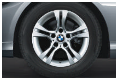
□ Jantes BMW en alliage léger style 268 à rayons doubles, 7 J x 16 pouces, pneumatiques 205/55 R 16.
