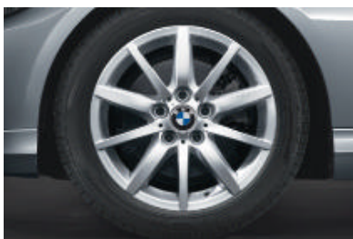
□ Jantes BMW en alliage léger style 286 à rayons en étoile avec monte pneumatique mixte, 8 J x 17 pouces à l'avant, pneumatiques 225/45 R 17; 8,5 J x 17 pouces à l'arrière, pneumatiques 255/40 R 17.
