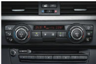
□ **Climatisation automatique**, avec recyclage automatique AUC, filtre microporeux et touche pour la chaleur résiduelle. Avec réglage individuel de la température à l'avant (à gauche et à droite), espace de rangement climatisé dans la console centrale, et climatisation et ventilation des places arrière dans la console centrale. De série sur toutes 330 et 335.
