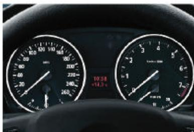
■ **Tableau de bord** avec instruments analogiques et éclairage rouge par transparence. Indicateur de vitesse avec jauge de carburant, compte-tours avec affichage de la consommation (de la température de l'huile sur BMW 335i), affichage LCD pour totalisateur de distance et totalisateur journalier, indicateur de température extérieure et montre.
