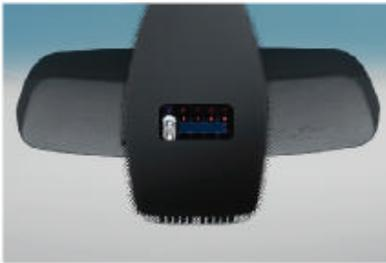
□ **Détecteur de pluie et allumage automatique des projecteurs.** Une fois activé, le détecteur enclenche automatiquement les essuie-glace dès les premières gouttes de pluie et commande la cadence du balayage en fonction de l'intensité de la pluie. L'allumage automatique des projecteurs actionne les feux de croisement dans l'obscurité ou dans un tunnel par exemple.
