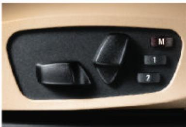
□ **Sièges avant partiellement électriques**. Réglages électriques : hauteur d'assise et inclinaison du dossier ; manuels : profondeur et inclinaison de l'assise.
