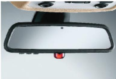
□ **Rétroviseur intérieur à anti-éblouissement automatique** avec miroir de grande dimension et liseuses à l'avant. Représenté ici avec l'option Télécommande universelle intégrée.
