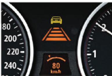
□ **Régulateur de vitesse actif ACC**. Il permet une conduite détendue à une vitesse prédéfinie. Sur la route, votre BMW adapte sa vitesse à celle du véhicule qui précède et maintient automatiquement une distance de sécurité prédéfinie (disponible uniquement sur les modèles 6 cylindres).
