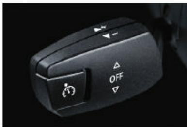
■ **Régulateur de vitesse**. A partir de 30 km/h environ, il mémorise et maintient la vitesse souhaitée (affichée au tableau de bord). Après une accélération, le régulateur rétablit automatiquement la vitesse enregistrée au préalable. Lorsque le conducteur freine, la fonction est désactivée. Les modèles 6 cylindres disposent en plus d'une fonction freinage.
