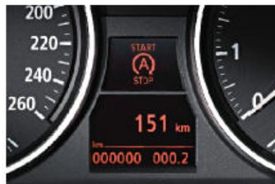
■ **Affichage de l'arrêt automatique du moteur**. Lorsque la fonction d'arrêt et de redémarrage automatique du moteur a coupé le moteur (par exemple à un feu tricolore ou dans un embouteillage), le conducteur en est informé via un symbole sur l'écran d'information. Ce dernier s'éteint à nouveau lorsque le moteur redémarre (sur les modèles 4 cylindres à boîte de vitesses manuelle).
