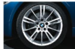
□ **Jantes BMW en alliage léger style 193 M à rayons en étoile**, avec monte pneumatique mixte RSC permettant le roulage à plat : 8 J x 18 pouces à l'avant, pneumatiques 225/40 R18 ; 8,5 J x 18 pouces à l'arrière, pneumatiques 255/35 R 18.
