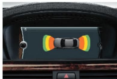
□ **Système d'aide aux manœuvres de stationnement PDC<sup>2</sup>**, à l'avant et à l'arrière ou uniquement à l'arrière : il facilite les manœuvres de stationnement dans un espace réduit. Le PDC indique que votre véhicule s'approche d'un obstacle par un signal acoustique (ou optique sur l'écran en combinaison avec un système de navigation).
