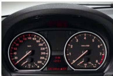
■ **Tableau de bord** avec instruments analogiques et éclairage rouge par transparence pour l'indicateur de vitesse et le compte-tours. Ordinateur de bord avec affichage à cristaux liquides pour le totaliseur de distance parcourue et le totaliseur partiel.
