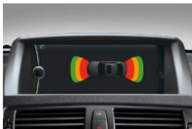
□ **Système d'aide au stationnement PDC,** disponible pour l'avant et l'arrière ou uniquement pour l'arrière. Il facilite les manœuvres sur les emplacements les plus étroits. La distance entre votre BMW et un obstacle est indiquée par un signal sonore (et visuel sur l'écran de contrôle en combinaison avec un système de navigation en option).
