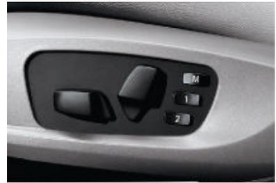
□ **Sièges avant à réglage électrique** de la hauteur de l'assise, de la position longitudinale du siège et de l'inclinaison du dossier, avec fonction mémoire pour le siège conducteur et les rétroviseurs ext. (avec basculement automatique du rétroviseur ext. au passage de la marche arrière). Deux positions du siège conducteur et des rétroviseurs ext. peuvent être enregistrées.
