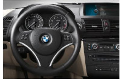
□ **Volant Sport gainé cuir multifonctions** (diamètre 369 mm), à trois branches, avec inserts chromés et touches multifonctions permettant de commander l'autoradio ou le téléphone (option). De série sur BMW 125i, 135i et 123d.
