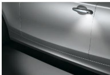
□ **Kit éclairage**. Il comprend des poignées de portes extérieures avec éclairage intégré illuminant pendant 20 secondes la zone d'accès au véhicule après le déverrouillage des portes. Autres équipements compris : liseuses à l'avant et à l'arrière avec éclairage d'ambiance, éclairage du bas de l'habitacle à l'avant et miroirs de courtoisie éclairés côté conducteur et passager avant.
