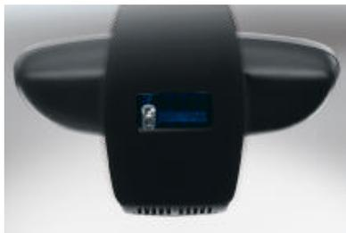
□ **Détecteur de pluie et allumage automatique des projecteurs.** Une fois activé, il enclenche automatiquement les essuie-glace et commande la cadence du balayage en fonction de l'intensité de la pluie. La fonction intégrée d'allumage automatique des projecteurs actionne les feux de croisement au crépuscule ou au passage dans un tunnel. De série sur BMW 125i, 135i et 123d.
