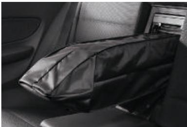
□ **Sac à skis**. Il permet de transporter en toute sécurité des skis sans salir l'habitacle. Lorsqu'il n'est pas utilisé, il peut être rangé derrière la trappe à skis pour économiser de la place.
