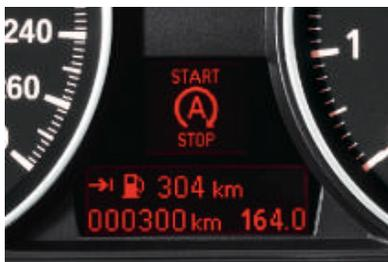
■ **Affichage de l'arrêt automatique du moteur.** Lorsque la fonction d'arrêt et de redémarrage automatique du moteur a coupé le moteur (par exemple à un feu tricolore ou dans un embouteillage), le conducteur en est informé via un symbole sur l'écran d'information. Ce dernier s'éteint à nouveau lorsque le moteur redémarre (fonction disponible sur les BMW 120d et 123d avec boîte de vitesses manuelle à 6 rapports).
