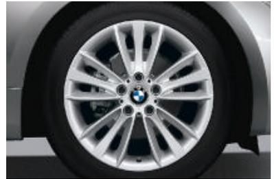
□ **Jantes BMW en alliage léger style 263** à rayons en W avec monte pneumatique mixte, 7,5 J x 18 pouces à l'avant, pneumatiques 215/40 R 18 ; 8,5 J x 18 pouces à l'arrière, pneumatiques 245/35 R 18.
