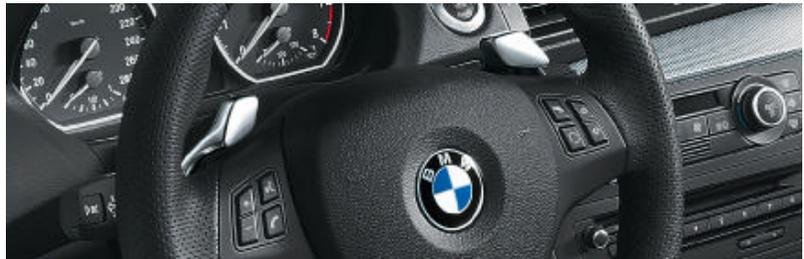
□ **Palettes au volant** (en combinaison avec la boîte de vitesses automatique à 6 rapports) permettant de changer de rapport manuellement sans débrayer. Non disponibles sur 120d.
