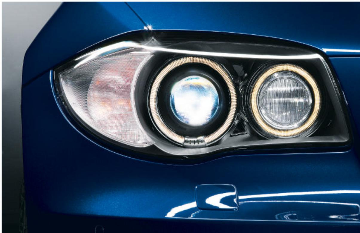
□ **Projecteurs bi-Xénon**, avec éclairage diurne, quatre anneaux lumineux et réglage automatique de la portée des projecteurs. Ils améliorent nettement l'éclairage de la chaussée la nuit, par mauvais temps ou par mauvaise visibilité.
