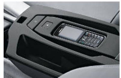
□ **Préparation pour téléphone portable Bluetooth** (avec dispositif libres et connexion pour recharger le téléphone et pour une antenne externe). Un adaptateur (disponible en accessoire) permet de raccorder un portable compatible Bluetooth pouvant aussi être commandé via l'iDrive nouvelle génération (uniquement avec un système de navigation).
