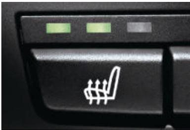
□ **Sièges avant chauffants** (à trois niveaux de réglage) : l'assise, le dossier et même les flancs des sièges sont chauffants. Ils diffusent une agréable chaleur en peu de temps.
