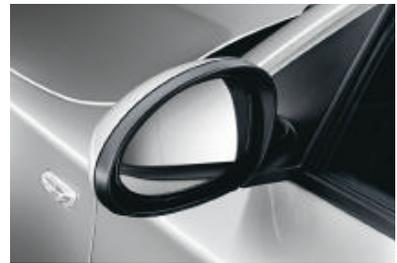
■ **Rétroviseurs extérieurs** asphériques dans la teinte de la carrosserie, chauffants et réglables électriquement.
