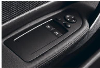
■ **Lève-vitres électriques** avec commandes par impulsion, fermeture confort et protection anti-pincement.
