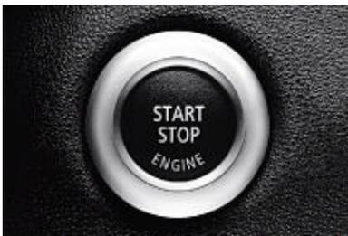
■ **Bouton de démarrage « Start/Stop ».** Il permet de mettre en route le véhicule après avoir inséré la clé à télécommande dans le contacteur de démarrage. Appuyer brièvement sur le bouton « Start/Stop » démarre ou arrête le moteur de votre BMW.
