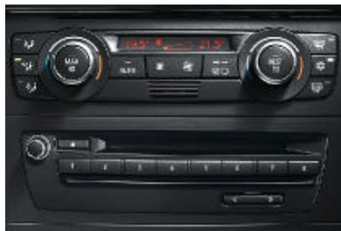
□ **Climatisation automatique** (ci-dessus) avec recyclage automatique de l'air AUC, filtre microporeux, capteurs de buée et d'ensoleillement, et touche pour la chaleur résiduelle. Elle établit rapidement la température sélectionnée et la maintient constante. Réglage individuel de la température gauche/droite. De série sur BMW 125i, 135i et 123d.
