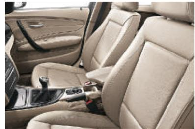
■ **Sièges de série** (revêtus du cuir Boston « Beige » optionnel sur la photo) avec réglages manuels des sièges, y compris réglage de la hauteur de l'assise pour les sièges avant.
