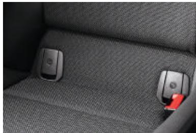
■ **Fixation ISOFIX** sur les sièges arrière permettant de mettre en place des sièges enfant grâce à un système d'ancrage qui s'encliquette de manière sûre.
