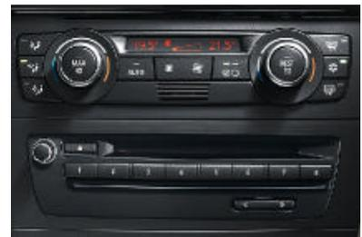
■ **Climatisation automatique avec mode cabriolet**, recyclage automatique de l'air AUC, filtre microporeux, capteurs de buée et d'ensoleillement, et touche pour la chaleur résiduelle. Elle maintient la température sélectionnée constante (réglage individuel de la température gauche/droite). Avec mode de climatisation spécifique au cabriolet.
