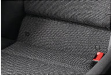
■ **Fixation ISOFIX** sur les sièges arrière gauche et droit permettant de mettre en place des sièges enfant grâce à un système d'ancrage qui s'encliquette de manière sûre.
