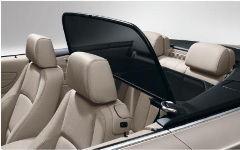
□ **Le filet anti-remous** permet de conduire à ciel ouvert sans courants d'air ni tourbillons au niveau des épaules et de la nuque. Il se manipule facilement et est relevable. Plié, il se range dans le coffre à bagages où il prend peu de place.
