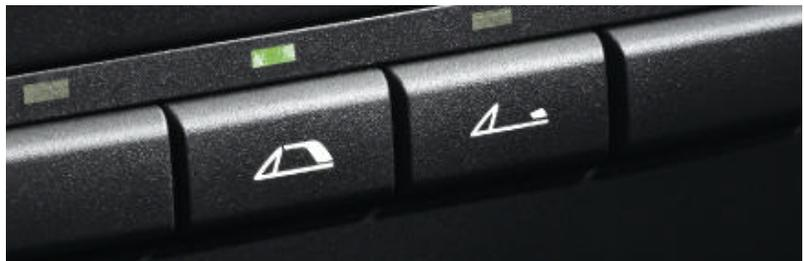
■ **Touches de commande de capote** pour ouvrir ou fermer la capote de manière entièrement automatique. L'ouverture peut être déclenchée en roulant jusqu'à 40 km/h et fonctionne jusqu'à 50 km/h.
