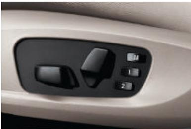
□ **Sièges avant à réglage électrique** de la hauteur de l'assise, de la position longitudinale du siège et de l'inclinaison du dossier, mémoires pour le siège conducteur et les rétroviseurs extérieurs (avec basculement automatique du rétroviseur au passage de la marche arrière). Deux positions du siège conducteur et des rétroviseurs extérieurs peuvent être enregistrées.
