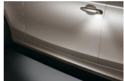
□ **Kit éclairage**. Les poignées extérieures avec éclairage intégré illuminent la zone d'accès au véhicule pendant 20 secondes après le déverrouillage des portes. Autres équipements compris : liseuses à l'avant, éclairage du bas de l'habitacle à l'avant, miroirs de courtoisie éclairés côté conducteur et passager avant et éclairage d'ambiance.
