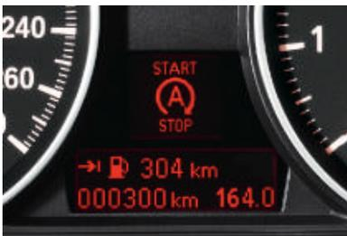
■ **Affichage de l'arrêt automatique du moteur.** Lorsque la fonction d'arrêt et de redémarrage automatique du moteur a coupé le moteur (par exemple à un feu tricolore ou dans un embouteillage), le conducteur en est informé via un symbole sur l'écran d'information. Ce dernier s'éteint à nouveau lorsque le moteur redémarre (sur les motorisations quatre cylindres avec boîte de vitesses manuelle à 6 rapports).
