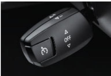
**Régulateur de vitesse.** A partir de 30 km/h environ, il mémorise la vitesse souhaitée (commande par le levier placé sur la colonne de direction, à gauche) et la maintient constante. La fonction se désactive lorsque le conducteur freine. Lorsqu'il l'actionne à nouveau le régulateur, le véhicule accélère jusqu'à atteindre la vitesse précédemment mémorisée.
