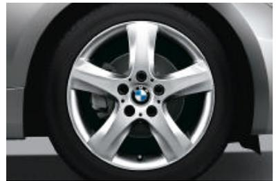
□ **Jantes BMW en alliage léger style 142** à rayons en étoile avec monte pneumatique mixte, 7 J x 17 pouces à l'avant, pneumatiques 205/50 R 17 ; 7,5 J x 17 pouces à l'arrière, pneumatiques 225/45 R 17. Non disponibles sur BMW 135i.
