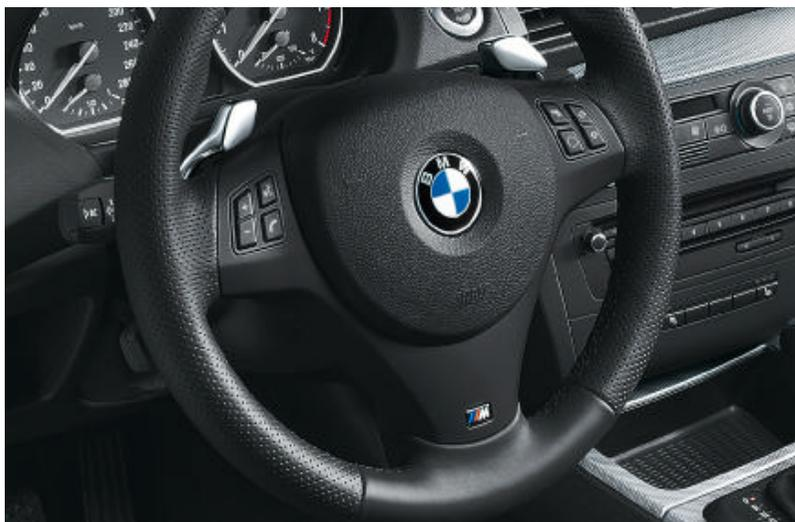
□ **Palettes au volant** (en combinaison avec la boîte de vitesses automatique à 6 rapports) permettant de changer de rapport manuellement sans débrayer. Disponible uniquement sur BMW 125i, 135i et 123d.
