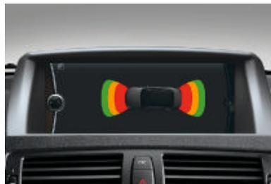
□ **Système d'aide au stationnement PDC**, disponible pour l'avant et l'arrière ou uniquement pour l'arrière. Il facilite les manœuvres sur les emplacements les plus étroits. La distance entre votre BMW et un obstacle est indiquée par un signal sonore (et visuel en combinaison avec un système de navigation en option).
