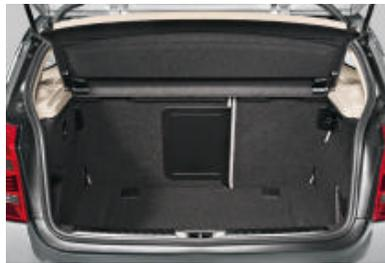
■ **Compartment à bagages**, entièrement recouvert de moquette et éclairé. Des objets peuvent être transportés en toute sécurité grâce à un cordon élastique (à gauche) et des œillets d'arrimage (à l'intérieur, sur le seuil de chargement).
