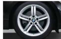
**Jantes BMW en alliage léger style 208M à rayons doubles avec monte pneumatique mixte permettant le roulage à plat.** Dimensions : 7,5 J x 18 pouces à l'avant, pneumatiques 215/40 R 18, 8,5 J x 18 pouces à l'arrière, pneumatiques 245/35 R 18. En option uniquement sur finition Sport Design.
