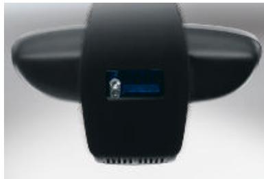
□ **Détecteur de pluie et allumage automatique des projecteurs**. Une fois activé, il enclenche automatiquement les essuie-glace et commande la cadence du balayage en fonction de l'intensité de la pluie. La fonction intégrée d'allumage automatique des projecteurs actionne les feux de croisement au crépuscule ou au passage dans un tunnel. De série sur les BMW 130i et 123d.
