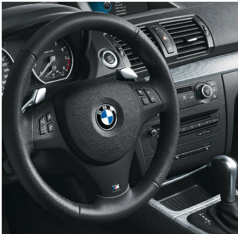
□ **Palettes au volant** pour une conduite particulièrement dynamique (en combinaison avec la boîte de vitesses automatique à 6 rapports avec Steptronic) ; disponibles pour le volant Sport gainé cuir ou le volant M gainé cuir.
