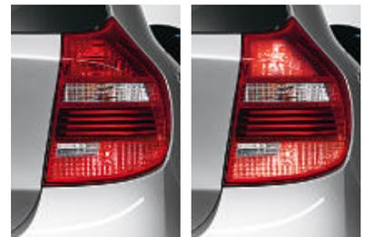
■ **Feux de stop bi-intensité**. Ils permettent aux automobilistes qui vous suivent de mieux évaluer votre intensité de freinage. En cas de freinage d'urgence, la surface éclairée des feux de stop s'agrandit. Il est ainsi plus facile de faire la différence entre un freinage léger et un freinage appuyé – pour encore plus de sécurité.
