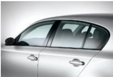
□ **Shadow Line extérieur** (de série sur BMW 130i et 123d 5 portes). Comprend l'enjoliveur du montant central, les pieds et triangles des rétroviseurs extérieurs en noir brillant.
