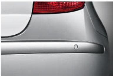
□ **Système d'aide au stationnement PDC**, disponible pour l'avant et l'arrière ou uniquement pour l'arrière. Il facilite les manœuvres sur les emplacements les plus étroits. La distance entre votre BMW et un obstacle est indiquée par un signal sonore (et visuel en combinaison avec un système de navigation).
