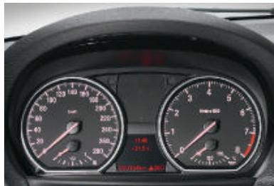
■ **Tableau de bord** avec instruments analogiques et éclairage rouge par transparence. Indicateur de vitesse, affichage à cristaux liquides pour le totaliseur de distance parcourue et le totaliseur partiel ainsi que pour l'ordinateur de bord, et compte-tours avec jauge de carburant intégrée.
