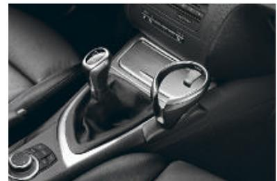
□ **Porte-gobelet**, enclipsable. Il se fixe sur la console centrale.
