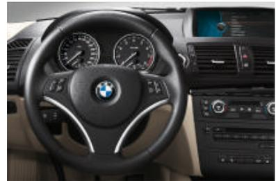
□ **Volant Sport gainé cuir multifonctions** (diamètre 369 mm), à trois branches et inserts chromés, avec touches multifonctions permettant de commander l'autoradio ou le téléphone (option). De série sur les BMW 130i et 123d.
