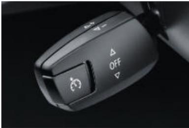
□ **Régulateur de vitesse.** A partir de 30 km/h environ, il mémorise la vitesse souhaitée (commande par le levier placé sur la colonne de direction, à gauche) et la maintient constante. La fonction se désactive lorsque le conducteur freine. Lorsqu'il l'actionne à nouveau le régulateur, le véhicule accélère jusqu'à atteindre la vitesse précédemment mémorisée. De série sur les BMW 130i et 123d.
