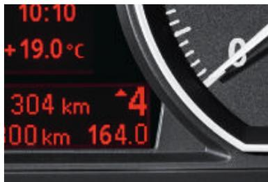
■ **Indicateur de changement de rapport** pour les modèles avec boîte manuelle à 6 rapports. Il favorise une conduite économique en indiquant le moment idéal pour passer le rapport supérieur ou rétrograder en fonction du style de conduite. Il vous conseille notamment de changer de vitesse à l'accélération si un autre rapport permet d'accélérer suffisamment vite en consommant moins.
