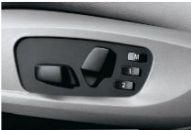
□ **Sièges avant électriques** : hauteur de l'assise et du dossier, position longitudinale du siège et inclinaison du dossier, avec mémoires pour le siège conducteur et les rétroviseurs ext. (avec basculement automatique du rétroviseur ext. au passage de la marche arrière). Deux positions du siège conducteur et des rétroviseurs ext. peuvent être enregistrées.
