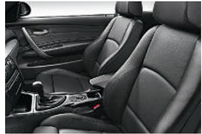
□ **Sièges Sport à l'avant** (revêtus du cuir Boston « Schwarz » optionnel sur la photo) assurant un maintien latéral optimal grâce au réglage électrique en continu de la largeur des dossiers. Avec réglage manuel de la position longitudinale du siège et de la hauteur de l'assise, de l'inclinaison du dossier et de l'assise et réglage de la longueur de l'assise.
