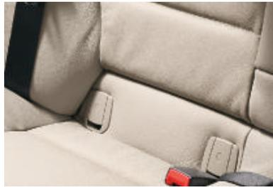
■ **Fixation ISOFIX** sur les sièges arrière gauche et droit permettant de mettre en place des sièges enfant grâce à un système d'ancrage qui s'enclenche de manière sûre. Avec ancrages supérieurs supplémentaires.
