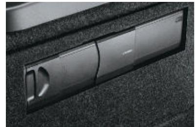
□ **Changeur de CD** dans le coffre à bagages, à gauche. Il peut contenir jusqu'à six CD.
