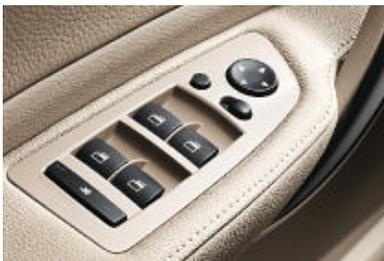
■ **Lève-vitres électriques à l'avant** avec commandes par impulsion, fermeture confort pour toutes les vitres et protection anti-pincement.
