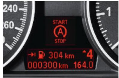
■ **Affichage de l'arrêt automatique du moteur.** Lorsque la fonction d'arrêt et de redémarrage automatique du moteur a coupé le moteur (par exemple à un feu tricolore ou dans un embouteillage), le conducteur en est informé via un symbole sur l'écran d'information. Ce dernier s'éteint à nouveau lorsque le moteur redémarre (sur toutes les motorisations 4 cylindres avec boîte manuelle).
