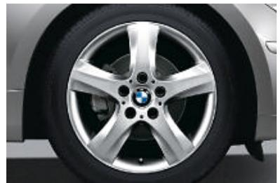
□ **Jantes BMW en alliage léger** style 142 à rayons en étoile avec monte pneumatique mixte, 7 J x 17 pouces à l'avant, pneumatiques 205/50 R 17 ; 7,5 J x 17 pouces à l'arrière, pneumatiques 225/45 R 17.
