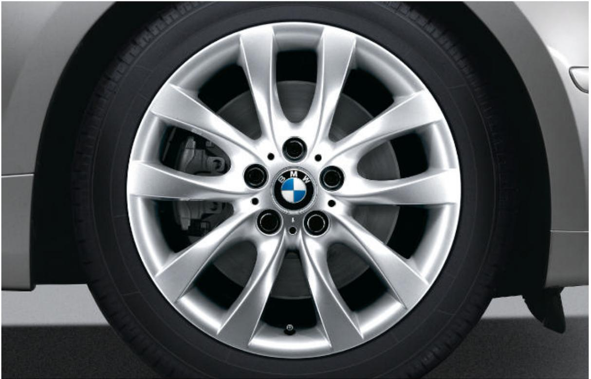
□ **Jantes BMW en alliage léger** style 217 à rayons en V avec monte pneumatique mixte, 7,5 J x 18 pouces à l'avant, pneumatiques 215/40 R 18 ; 8,5 J x 18 pouces à l'arrière, pneumatiques 245/35 R 18.
