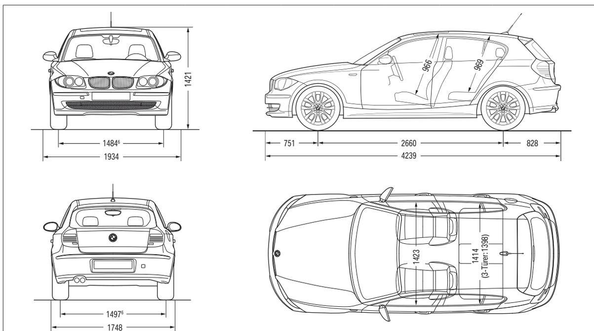
Toutes les cotes (BMW Série 1 5 portes sur les dessins cotés) sont indiquées en millimètres. Capacité du coffre à bagages : 330 à 1 150 litres environ (suivant VDA).
