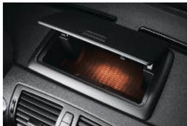
□ **Le kit rangement** comprend deux portegobelets, des filets sur les dossiers des sièges conducteur et passager avant, une prise 12 V dans le coffre à bagages, deux œillets d'arrimage rabattables, deux sangles de maintien sur le fond du coffre ainsi qu'un compartiment de rangement éclairé dans la partie supérieure de la planche de bord (non disponible en combinaison avec un système de navigation).
