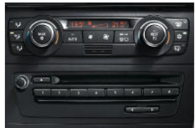
□ **Climatisation automatique** (ci-dessus) avec recyclage automatique de l'air AUC, filtre microporeux, capteurs de buée et d'ensoleillement, et touche pour chaleur résiduelle. Réglage individuel de la température gauche/droite. De série sur les BMW 130i et 123d.
